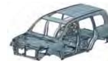
耐蚀钢板有助于防止车身受到侵蚀与损坏
